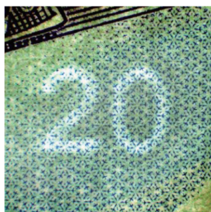
图9 面额数字白水印防伪效果示意图
